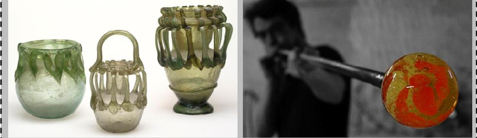
On attribue l'invention de la technique de soufflage du verre aux Phéniciens ou aux Babyloniens entre les III<sup>ème</sup> et I<sup>er</sup> siècles av. J.-C. L'invention de la canne à souffler permet de fabriquer des objets en verre plus facilement, plus rapidement et donc à moindre coût, ce qui démocratise l'usage du verre pour les récipients.
