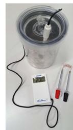
On dispose d'un **calorimètre\***, d'un thermomètre, d'un chronomètre et du montage avec rhéostat qui permet de faire passer un courant ajusté à l'intensité **4 A** dans un fil métallique immergé dans l'eau.
