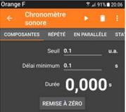
Le chronomètre **ne doit pas démarrer !** Si le chronomètre démarre à cause du bruit ambiant, régler le **seuil** à une valeur légèrement plus élevée.
