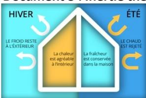
Un des problèmes rencontrés dans les maisons passives est leur faible inertie thermique car les matériaux utilisés sont souvent peu denses (paille, bois...). Deux systèmes permettent de valoriser le rayonnement solaire, le mur trombe et le mur capteur, en associant 2 propriétés physiques : l'effet de serre à travers le vitrage et l'inertie du mur.
