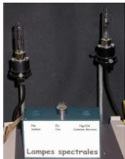
✂ Observer, avec le spectroscope, les 3 lampes à vapeur de sodium, d'hydrogène et de néon.
